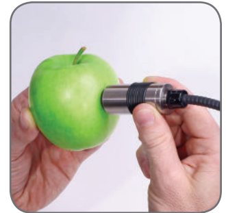
Unser einzigartig kleiner externer Standard Messkopf 45°/0°
