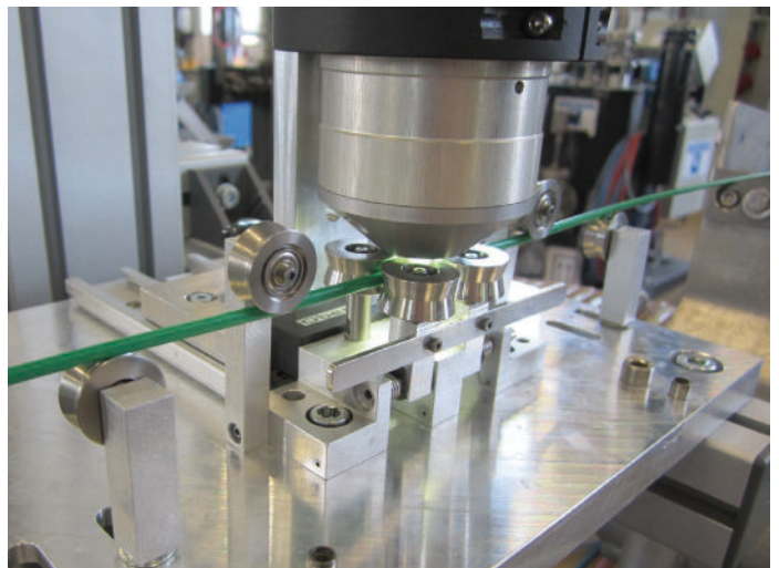
Bild 6: Rollenführung einer Farbmessung am Kunststoffstrang
