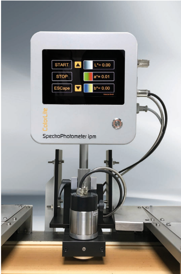
Bild 4: Gerät mit externem Messkopf zur Integration für Folienmessung
