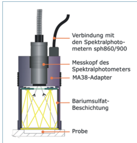
Bild 2. Adapter zur Vergrößerung des Messkopfs
